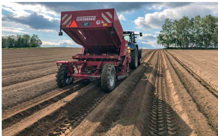
Obr. 1: Miskovitý tvar vrcholu hrobčekov, vytlačená nekoľajová brázda.
