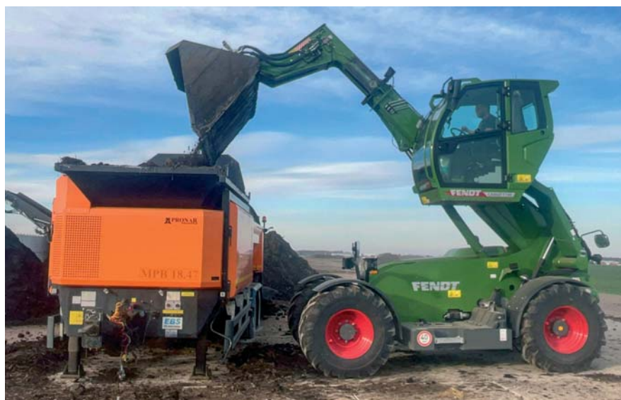
Na manipuláciu využívajú teleskopický nakladač Fendt Cargo T740.
