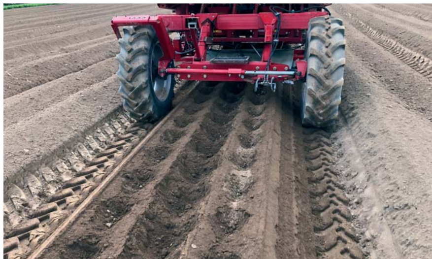
Obr. 2: Jamky a hrádzky vytvorené modulátorom hrobčekov umiestneným na sadzači.
