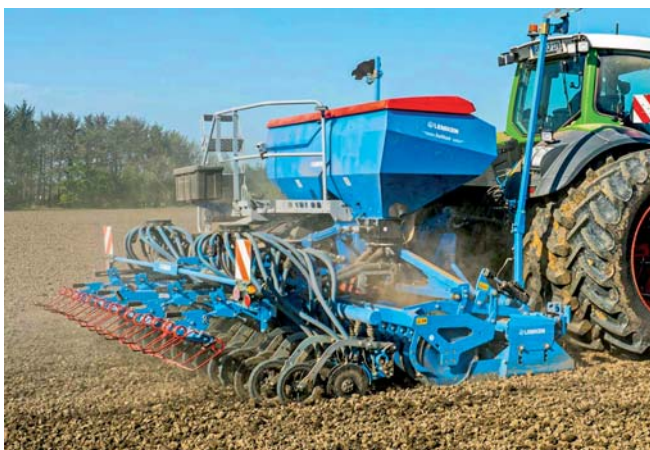
Kombináciu sejačky LEMKEN Solitair MR a rotačných brán Zirkon MR je možné použiť na konvenčné aj konzervačné obrábanie pôdy.
