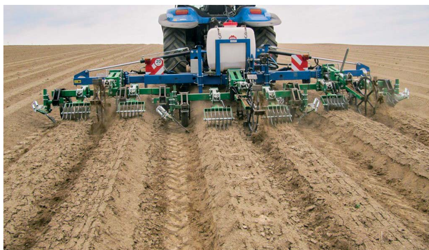
Obr. 3: Kyprenie hrobčekov s prihnojením a obnovou jamiek v nekoľajovej brázde.
