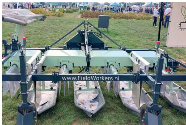
Chytač, sklepač pásavky od firmy Field Workers určený predovšetkým pre ekologickú výrobu.
