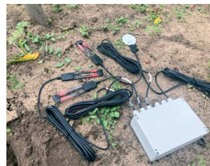
Pôdne senzory MeteoAG™ sensor node.
